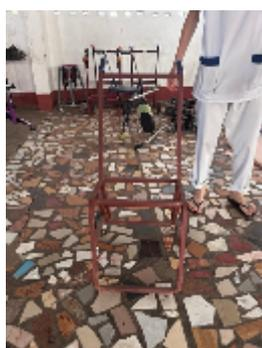
Adaptation d'un diable, sert à porter le SOB. Fixation du SOB par crochets.
